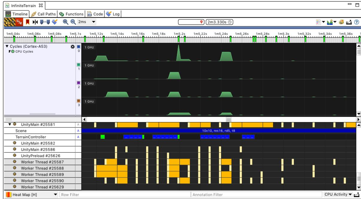
我們可以看到 CPU 活動的激烈程度降低許多，而且在主要執行緒中，已完成工作的藍色區塊也短了許多，因此畫面播放速率會比第一個場景順暢（但是當然整體上會有更多作業，因此我們必須確保地形產生速率仍然能跟上鏡頭飛越地形的速率）。
