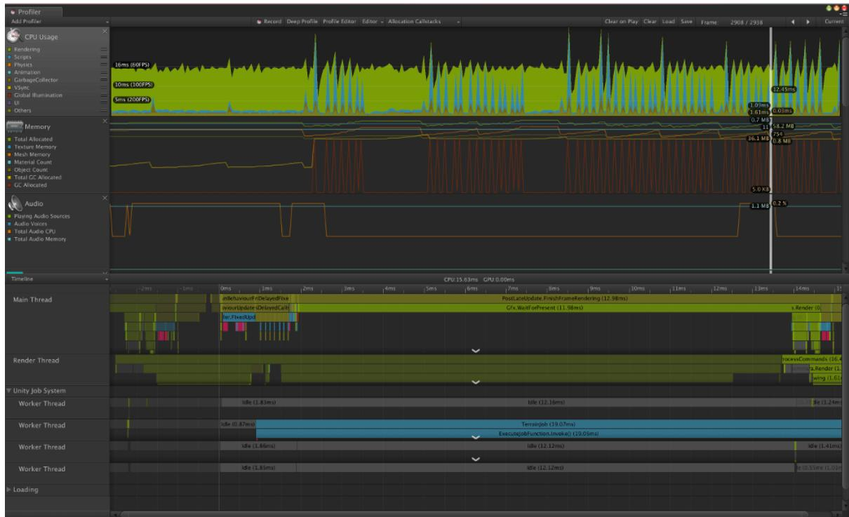
Unity 的剖析工具在顯示作業排定時間上極為出色，但是不會顯示平台實體資源（在本文中指的是 CPU 和 GPU）的詳細資料，以及這些資源的使用情形。我們或許達到 60 FPS 的目標，但是否也為此而達到所有 CPU 核心的最大極限，並且耗盡電池電力？在這種情況下，Streamline 正好能派上用場。本文接下來的部分將展示 Streamline 會擷取和顯示哪些資料，以及我們能如何使用 Streamline 的註解功能，將一些高階情境從 Unity 遊戲傳遞到 Streamline，讓資料更容易解讀。
