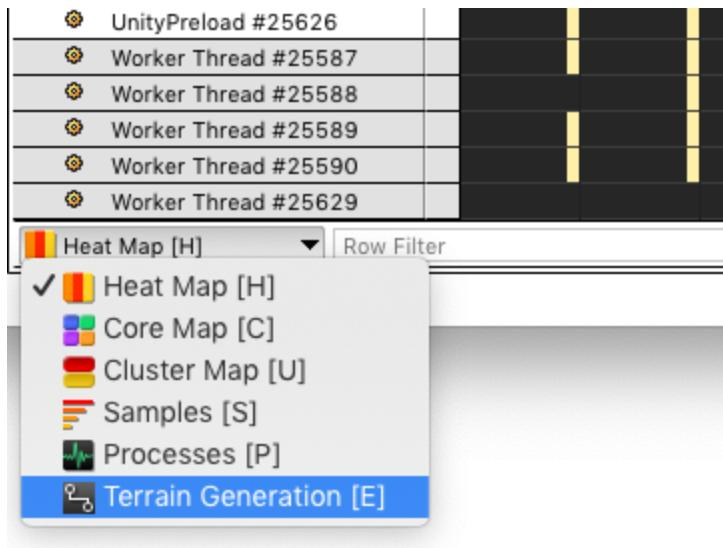
當我們選取「地形產生」檢視時，會看到每個地形產生活動都有一個色塊，上面顯示地形生成活動的開始與停止時間，如果將滑鼠游標移到色塊上方，就會顯示地形磚的座標、起始時間，以及完成所花時間。在此螢幕擷取畫面中，我們以圖表顯示在 Mali GPU 上進行的運算工作，正如我們的預期，隨著地形逐漸填滿，GPU 活動也穩定增加。此螢幕擷取畫面的擷取時間點是在第一個場景開始時，當時我們正在產生大塊地形磚，最多同時產生 8 塊。主要執行緒因準備所有新網格期間所發生的停頓，導致 GPU 長時間閒置：
