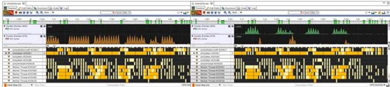
「UnityMain」執行緒相關的 CPU 剖析檔顯示 Cortex-A73 CPU 上的活動大量暴增。所有「Worker Thread」相關的 CPU 剖析檔顯示 Cortex-A73 與 Cortex-A53 CPU 上的活動較小量暴增。
