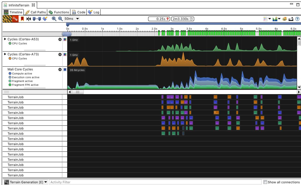
接著移到第四個場景，在這裡我們依序產生較小塊地形磚，可以看到 GPU 活動上揚的幅度順暢許多，而且可以明顯看到，同一時間只有一項地形作業正在執行(而且因為使用較小塊地形磚，所以每項作業都較短)：
