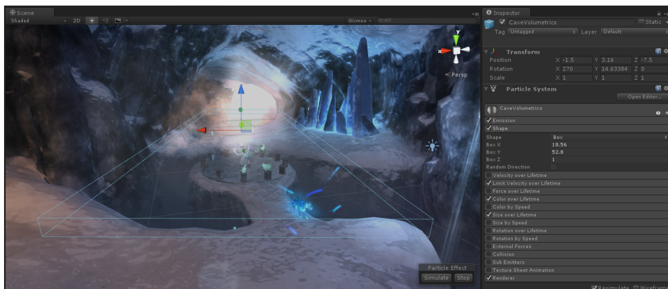
图 8-61 生成粒子的粒子方框定义
