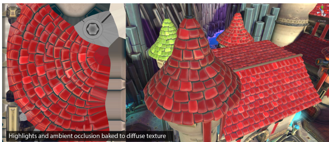
图 6-12 烘焙到纹理中的细节示例
